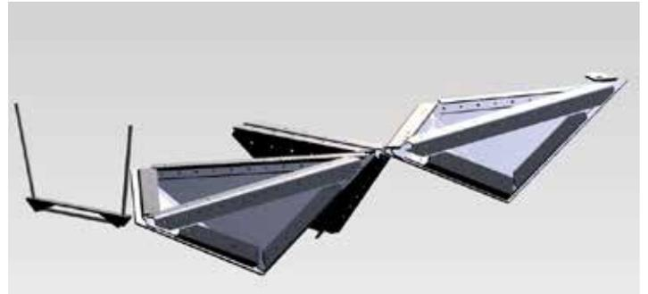
Double hélicoïdale d'innox brut plié, riveté, boulonné, suspendu, formant deux escaliers.
