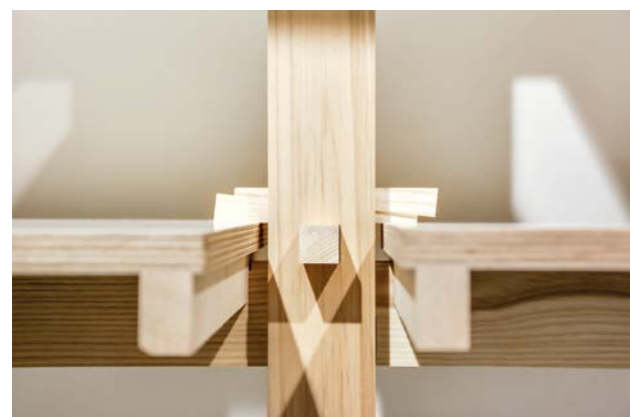
▲ Les clés en bois bloquent les plateaux de part et d'autre de chaque montant d'étagères.
