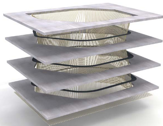
▲ ▲ Habillage en bois (Yellow Pine ignifugé) de l'atrium de l'immeuble Le Hub Créatic au parc d'innovations de La Chantrerie, à Nantes (44). Création : Tetrarc. Ingénierie design, conception, fabrication : Métalobil.
