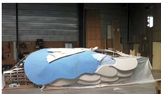
▲▲▲ Mobilier du bar Le Nid à la tour Bretagne à Nantes (44). Imaginé sous la forme d'une cigogne, le meuble principal du bar a été réalisé en structure aluminium revêtu de simlicuir. Création : Jean Jullien. Ingénierie design, fabrication : Métalobil.
