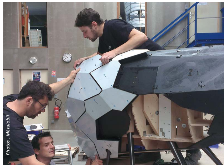
▲ Une banque d'accueil en inox poli miroir pour le siège de Groupama à Paris (75). Structure intérieure en contreplaqué. La réalisation reprend la forme d'une larve de phrygane portant son fourreau, une évocation du travail de l'artiste Hubert Duprat.
